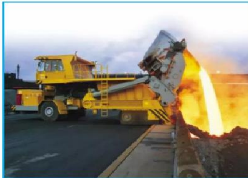
Figura 7: Escória sendo basculada no pátio Dry pit
