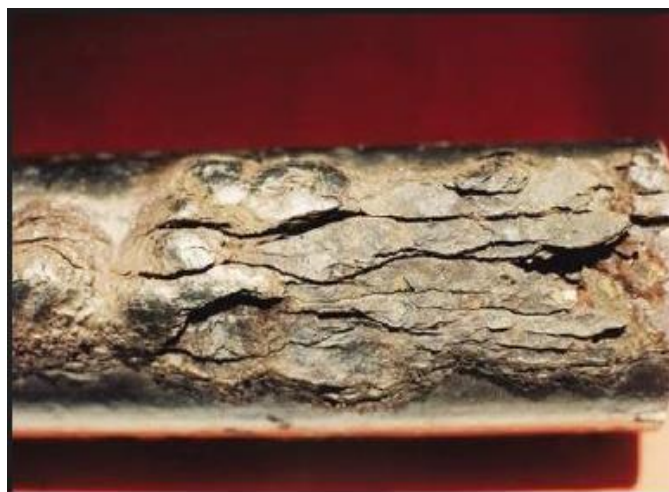
Figura 11: corrosão por esfoliação
